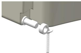
**1º passo:** Encaixar o Parafuso na Base do Eixo
