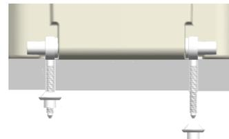
**3º passo:** Encaixe a porca no parafuso, pela parte inferior da louça sanitária.
